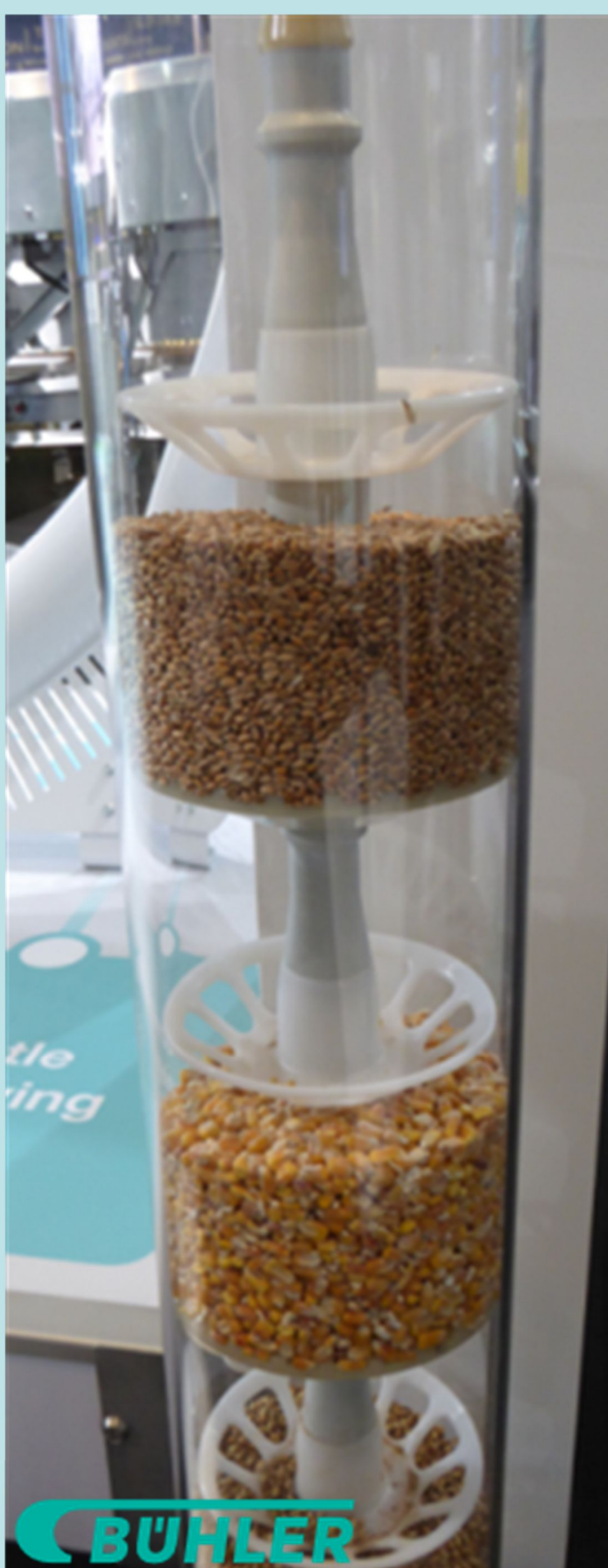
Schüttguttransport durch Schubelemente
